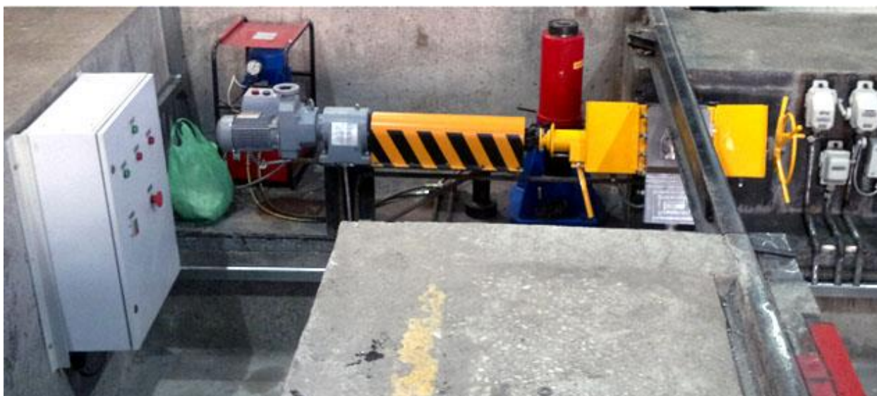
Рис. 4. Внешний вид диагностируемого ЭП с ПЧ (ООО «Транс-Атом»)
