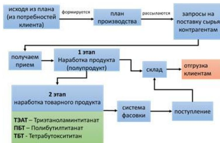
Рис. 2. Схема производства химической продукции (ТЭАТ, ПБТ, ТБТ)
