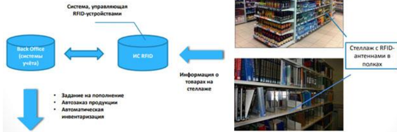
Рис. 2. Схема работы RFID системы на складе
