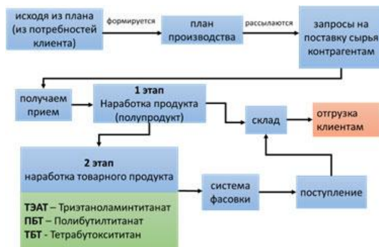
Рис. 2. Схема производства химической продукции (ТЭАТ, ПБТ, ТБТ)
