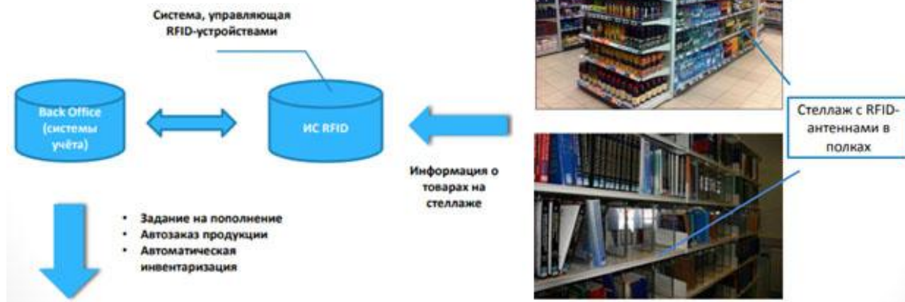
Рис. 2. Схема работы RFID системы на складе
